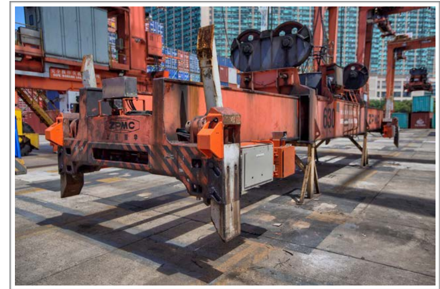
■ 裝置在吊機排架上的Magic Eye（灰色金屬盒）
