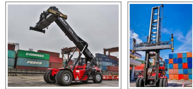
■（左圖）伸延式貨櫃吊機（象）；（右圖）堆高機（鷹） 「鷹」及「象」在有需要時會出動在堆場內「拉龍」
