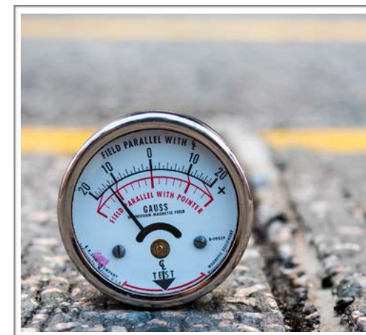
■ 用來測量磁力的高斯計（Gauss Meter）
